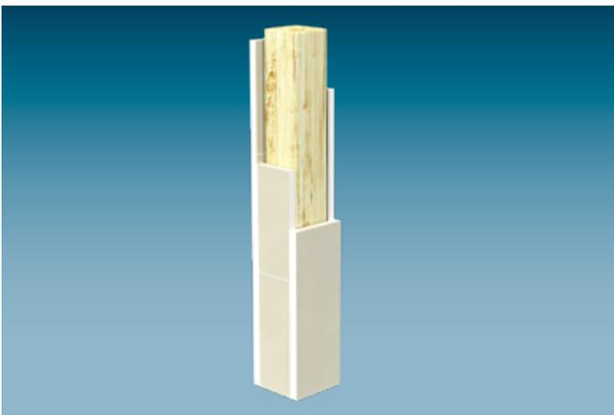
Das System **K255.at** Knauf Fireboard Holzstützen-Bekleidung wird ohne Unterkonstruktion ausgeführt. Die Befestigung der Bekleidung erfolgt durch stirnseitiges Verklammern in die Fireboard.
