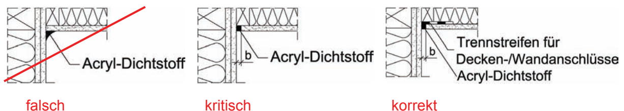
Abbildung 56: Ausführungen der Anschlussfugen von Gipsplatten [Quelle: ÖNORM B 3415]
