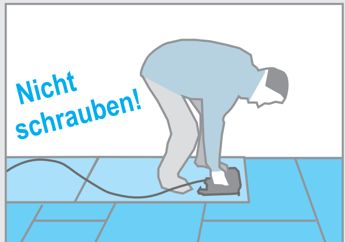
Nagelung mit Druckluft-/Impulsnagler stehend auf dem zu befestigendem Element
