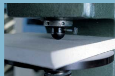
Knauf Diamant im Härte-test
