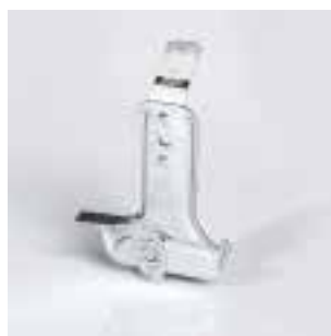
Ankerfix-Schnellabhänger für CD 60/27 mit Drehhebelverriegelung zur Profilfixierung, abgehängt durch Draht mit Öse Mat.Nr. 46821
