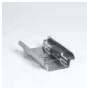
Multiverbinder für CD 60/27 zur Längsverbinding von CD-Profilen und zur flexiblen Verbindung mit Adaptern Mat.Nr. 65153
