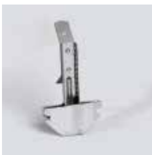
Kombihänger für CD 60/27 abgehängt durch Draht mit Öse oder mit Noniussystem. Sicherer Sitz im Profil durch Doppelclip, Tragfähigkeit in Abhängigkeit zur Anwendung Mat.Nr. 3412
