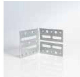
Anschluss- und Verbindungs- winkel für UA-Profile verbindet UA-Profile in flexiblen Winkeln, z.B. im Cubo-System Mat.Nr. 69798
